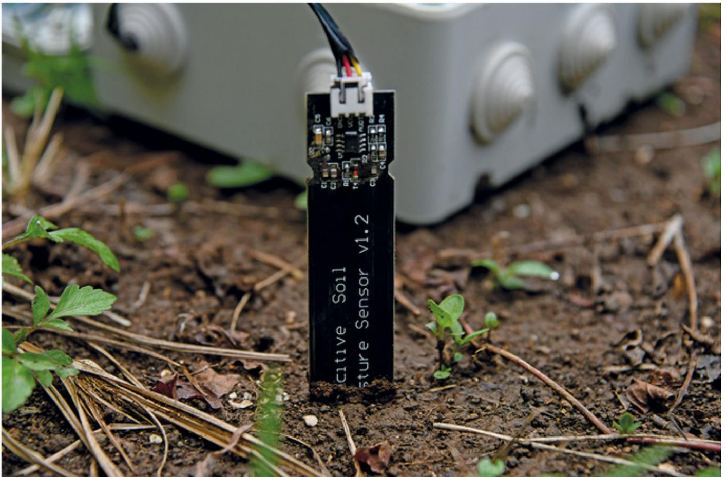
A través del trabajo que se realizó en este TCU, se logró elaborar una red de conexión integrada por cinco sensores ubicados en diferentes puntos de un terreno, con la que se logra captar los datos en forma continua y así el agricultor puede tener toda la información en la aplicación y revisarla, sin necesidad de recorrer toda la finca. Foto Laura Rodríguez.
