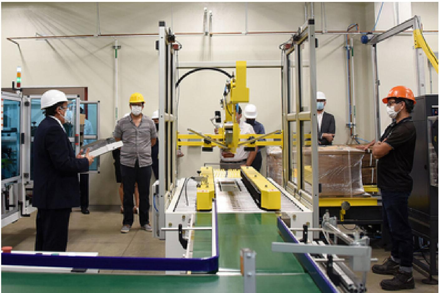
En el Laboratorio de Manufactura y Logística 4.0 se puede recrear un flujo continuo de producción, que inicia con el ensamblaje de cajas, la inyección o termoformado de partes, y el estibamiento en una línea de flejeo y empaque automático. Durante todo el recorrido
