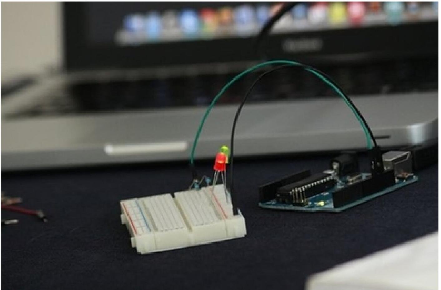
Arduino es una plataforma de hardware libre, basada en una placa con un microcontrolador y un entorno de desarrollo (software), diseñada para facilitar el uso de la electrónica en proyectos multidisciplinarios.
