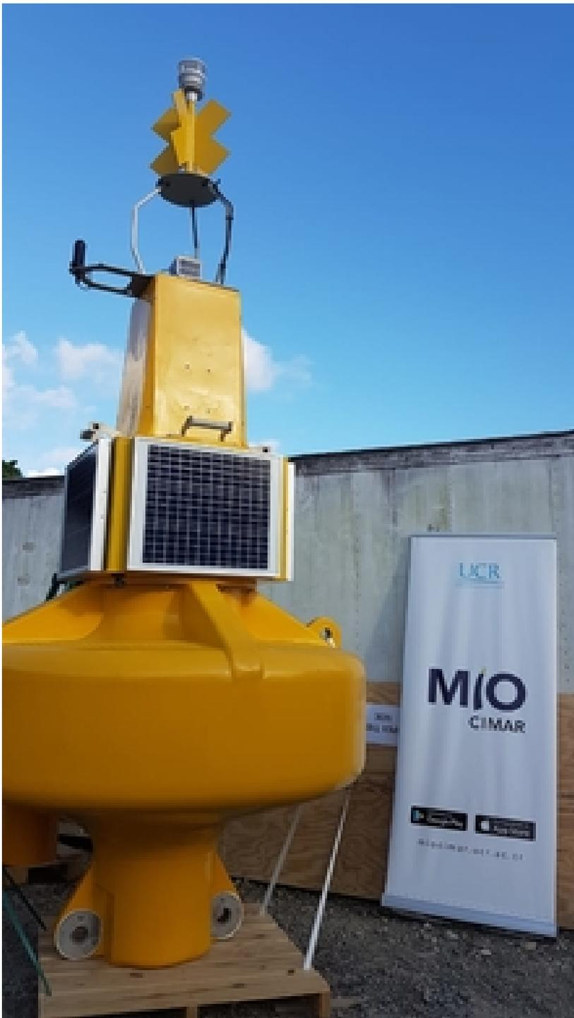
La boya, como se le llama al instrumento, tiene un radio de 3 metros por casi 3 metros de altura. Va sostenido debajo del mar, de manera que no se mueva con el movimiento del agua. Foto: cortesía de Rodney Mora.
