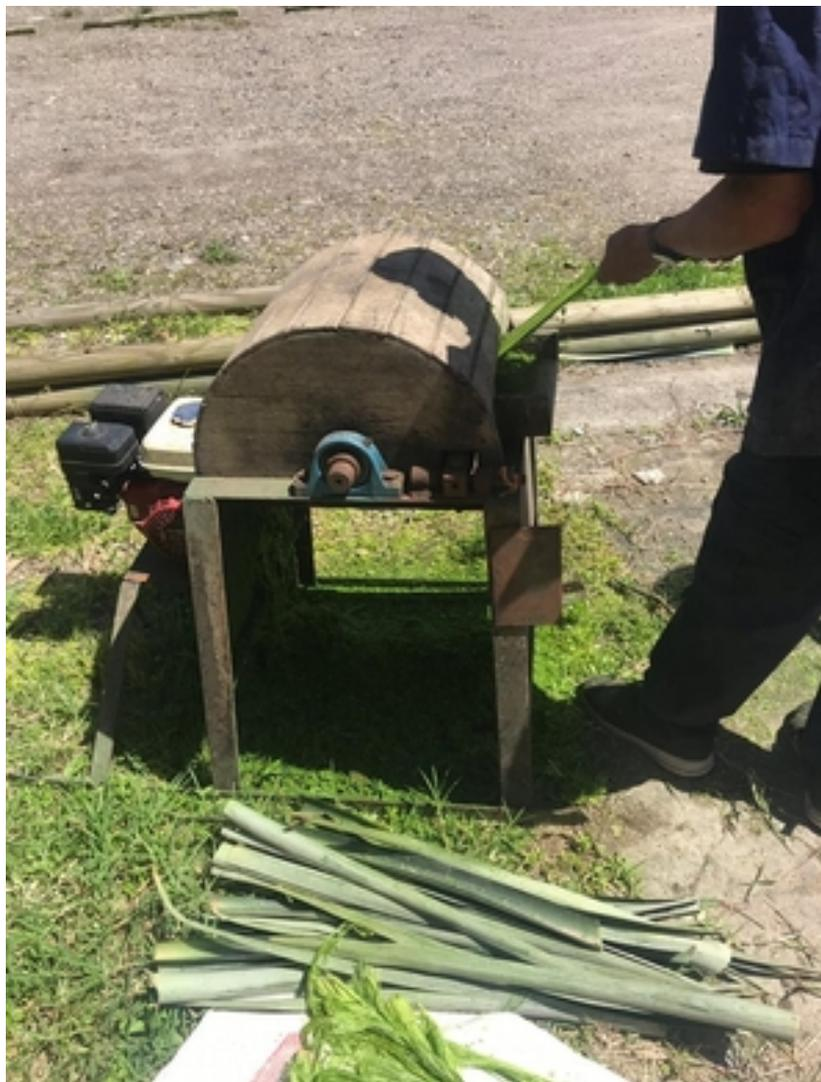
Durante el proceso de obtención de la cuerda natural a partir de las hojas de la piña, se utilizó una máquina decorticadora o desfibradora creada por expertos del TEC. Foto cortesía Esteban Valverde.
