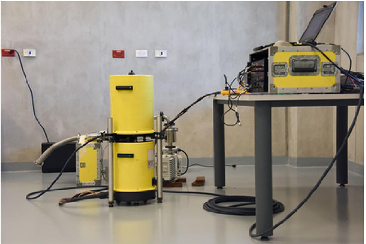
En el Laboratorio de Medición y Calibración de la Escuela de Ingeniería Topográfica de la UCR se realizaron varias pruebas con el gravímetro absoluto (foto Laura Rodríguez).
