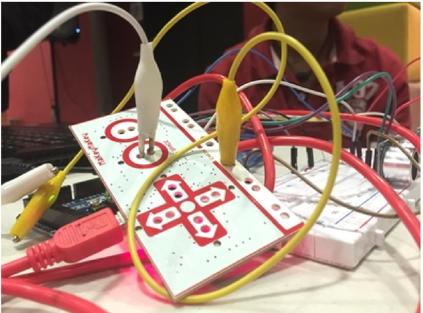
Makey-Makey es una placa con una distribución de botones y con un circuito que se cierra mediante contactos o pinzas de cocodrilo, logrando así el mismo input que al pulsar un botón, lo cual permite convertir cualquier objeto en un teclado, un mando o un mouse y así enviar órdenes a la computadora.
