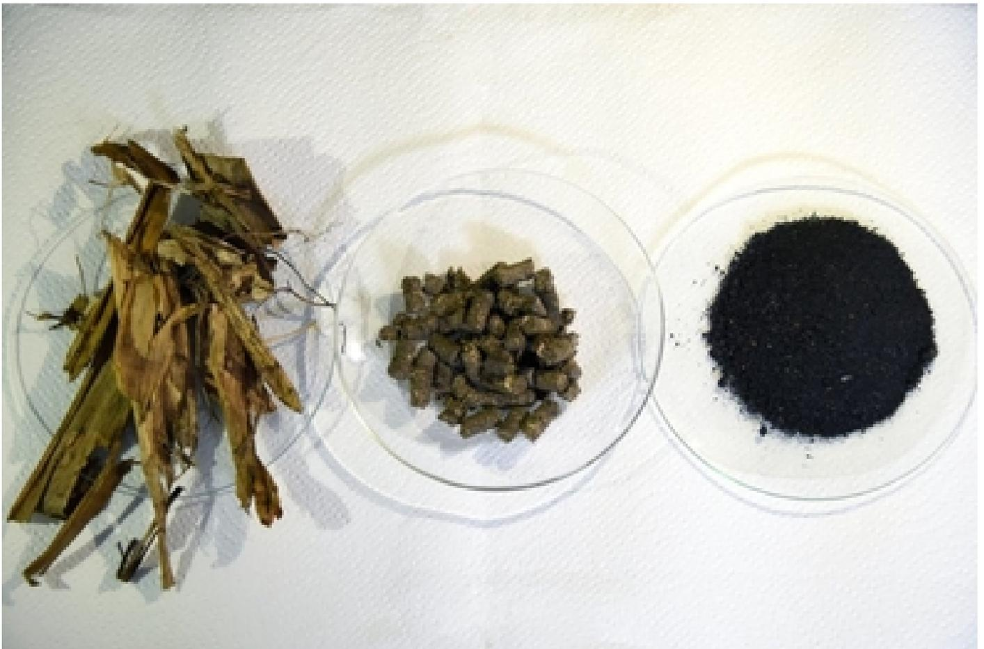
Para la producción de biocarbón, primero se seca el rastrojo de la piña, luego se hacen pequeñas porciones comprimidas, conocidas como pellets, que pasan por un proceso de pirólisis y, finalmente, el producto carbonizado se muele.
