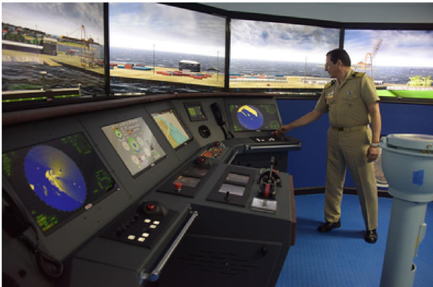
El simulador naval ofrece una visión de 240 grados y es operado mediante un avanzado software que logra recrear el arribo a un muelle o puerto, en condiciones climáticas que pueden cambiar de acuerdo a lo que se requiera evaluar. (foto Anel Kenjekeeva)
