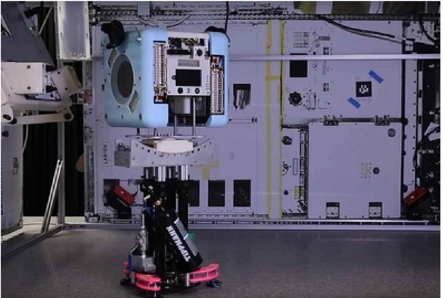
El robot Astrobee forma parte de la nueva generación de robots de asistencia e investigación espacial de la NASA, tiene forma de cubo y mide apenas 30 centímetros por cada lado (foto cortesía de la NASA).
