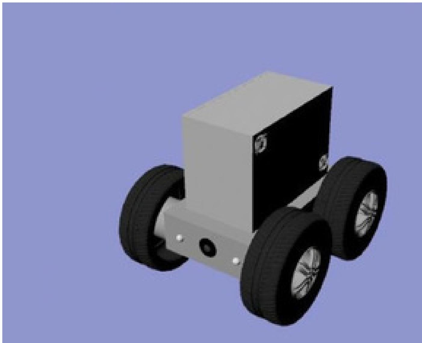
El robot es un carro a control remoto de aproximadamente 50 centímetros de alto. Trabaja con batería y usa sensores para la detección. Puede operar en forma autónoma entre 30 minutos y una hora (foto cortesía TC-629).
