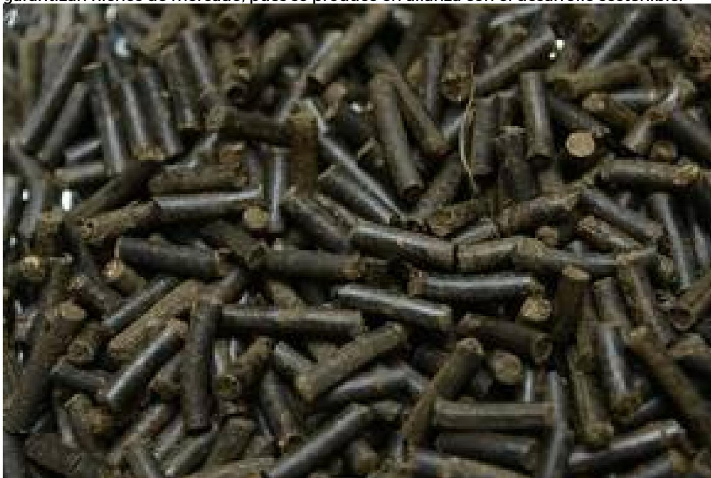
Los *pellets* se obtienen al pasar los residuos de la piña por un proceso de tratamiento y funcionan como combustible para que la planta de gasificación produzca energía eléctrica (foto: Laura Rodríguez).
