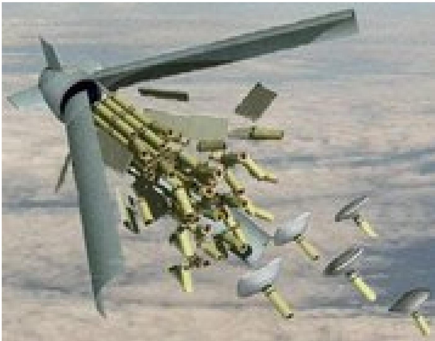
Las bombas de racimo son armas lanzadas desde un avión, con artillería o con misiles, que constan de un contenedor que se abre en el aire y dispersa submuniciones explosivos o “bombetas” sobre una amplia área (foto tomada de [www.humbertosilvacubillan.blogspot.com](http://www.humbertosilvacubillan.blogspot.com)).
