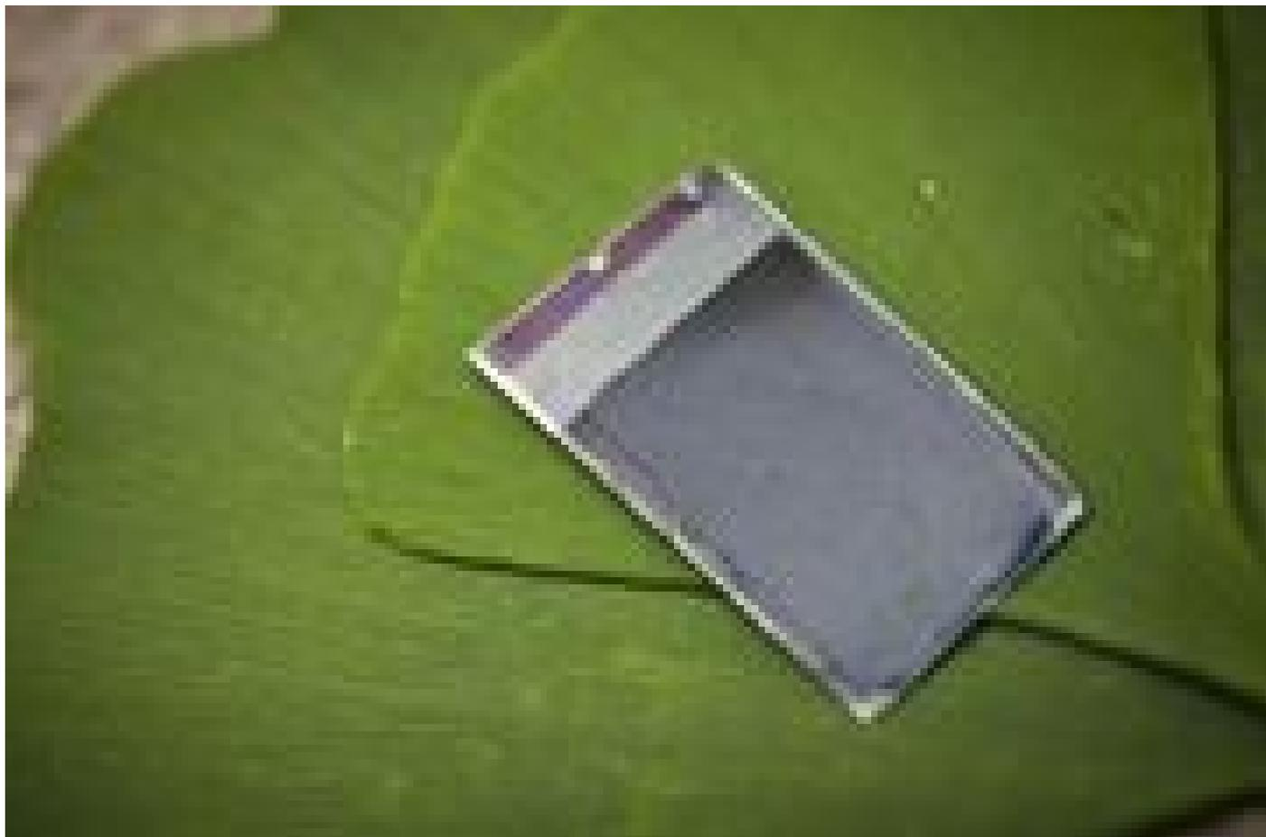
Este es un ejemplo de la Hoja Artificial elaborada por el Dr. Nocera y un equipo de expertos en energía, que tiene como fin dividir la energía proveniente del sol en compuestos químicos para lograr un almacenaje eficiente (foto: cortesía Dr. Esteban Durán).
