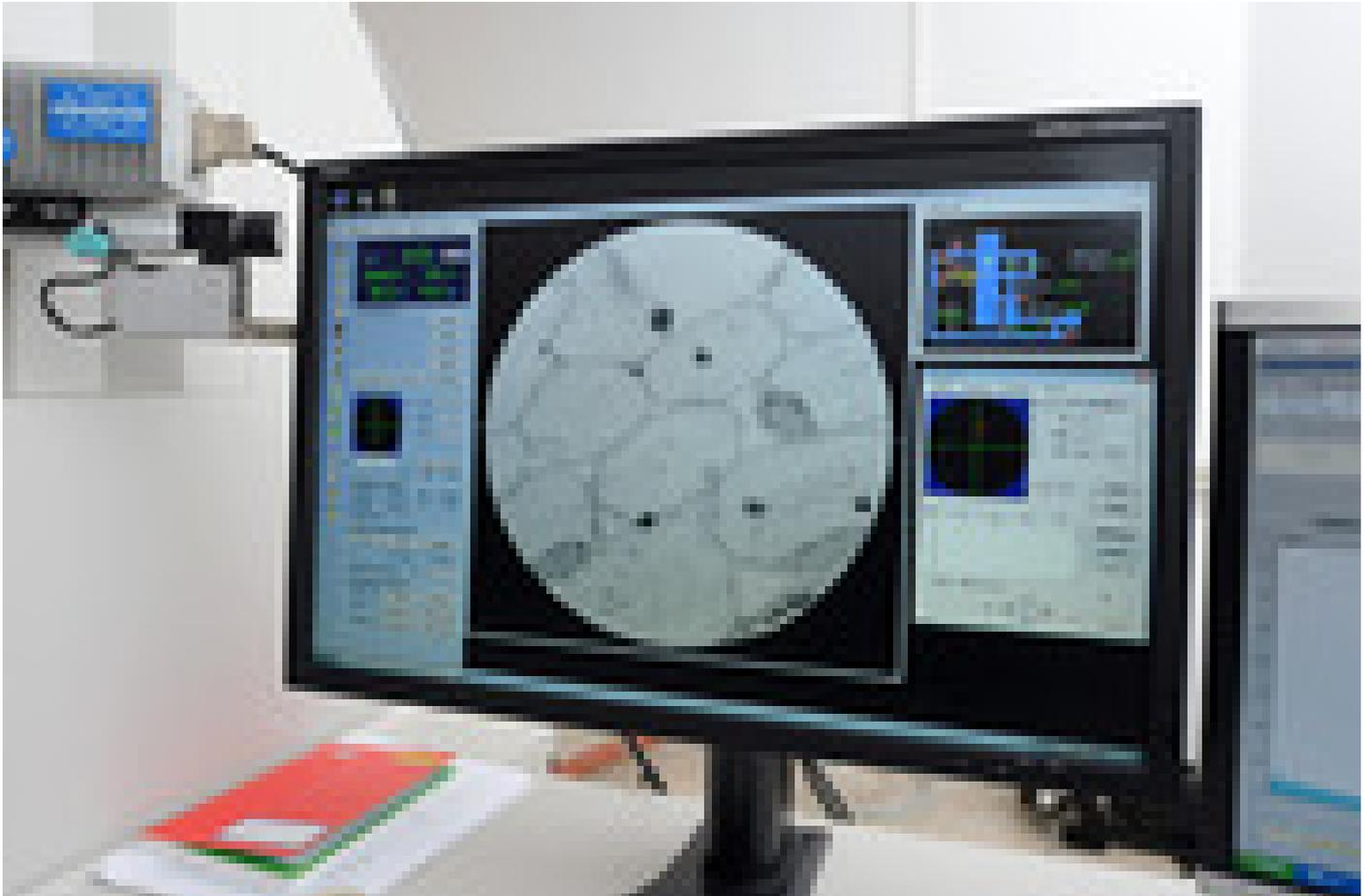
La pantalla del nuevo microscopio electrónico de transmisión tiene una extraordinaria capacidad de ampliación de las imágenes de hasta 600 mil veces y aporta una gran cantidad de información de las muestras analizadas (foto Rafael León).
