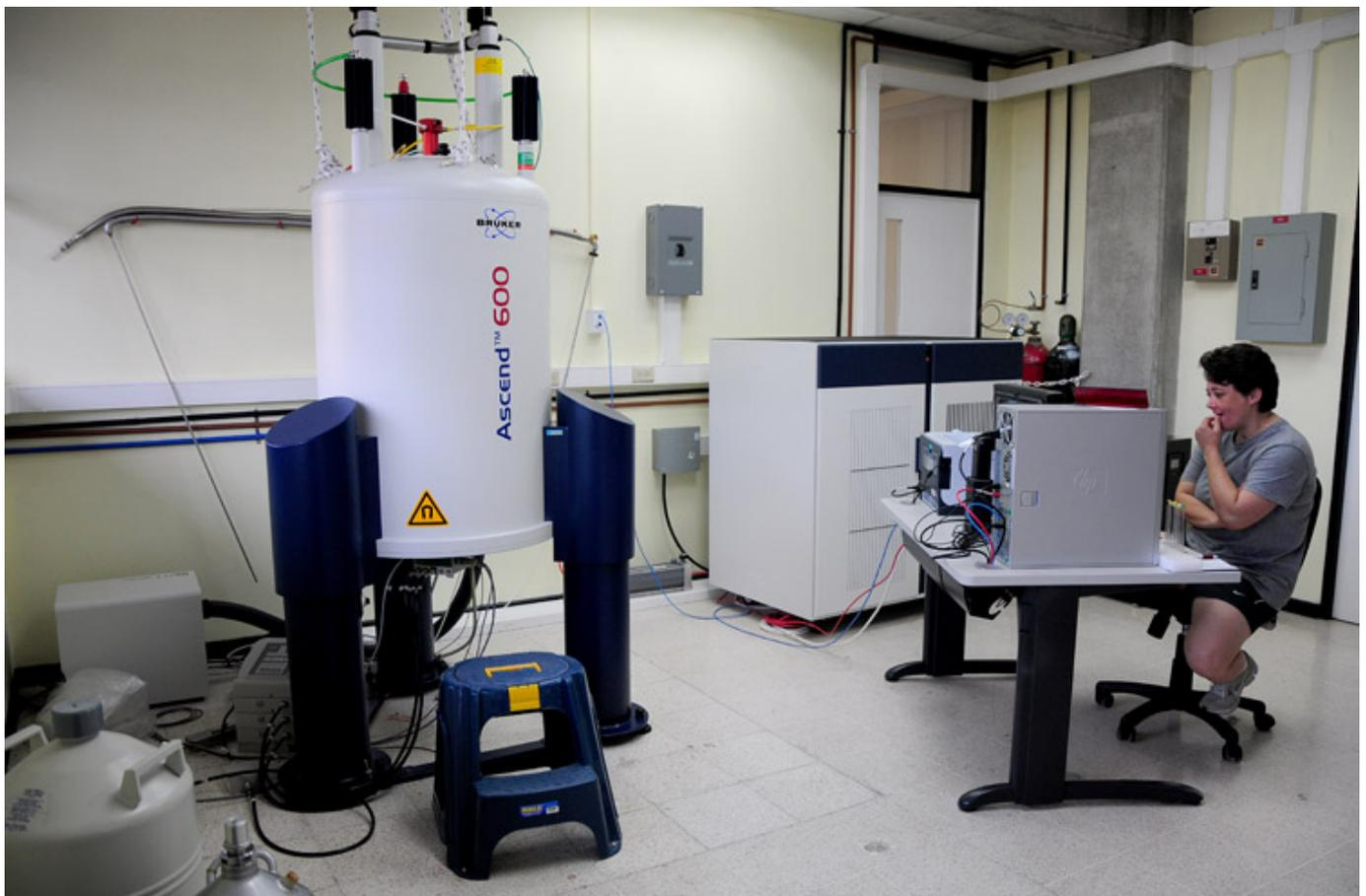
Parte de las instalaciones del Ciprona, en la Ciudad de la Investigación de la UCR. Este es el Espectrómetro de Resonancia Magnética Nuclear (Anel Kenjekeeva).
