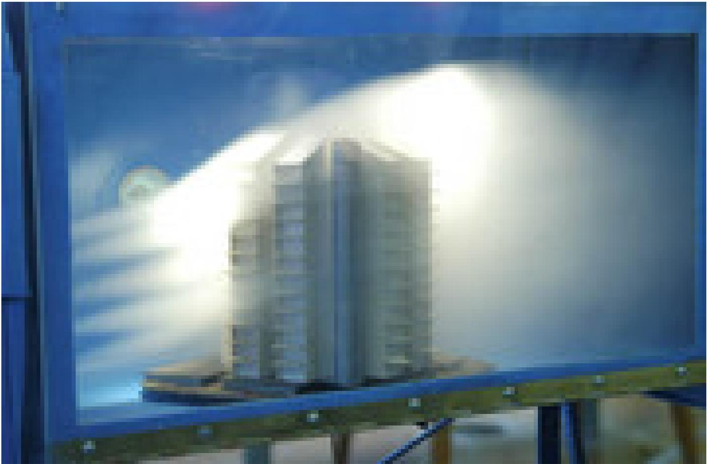
En la demostración del túnel se observa como esta maqueta es azotada por una corriente a la que se le aplicó humo para poder observar la acción del viento.
