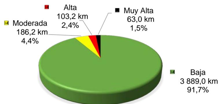
Figura 2. Condición Estructural de la Red Vial, según las deflexiones
