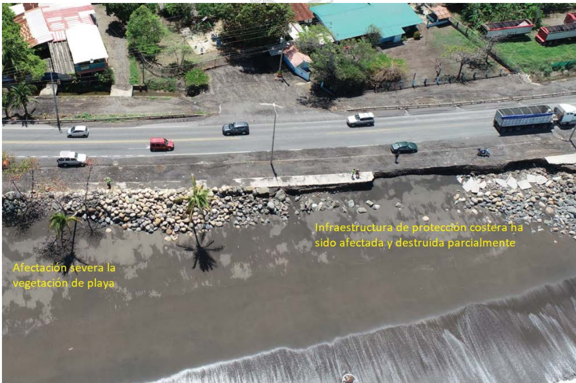
Figura 25. Fotografía aérea donde se aprecian algunas de las evidencias de la erosión costera severa en el sector de playa Caldera y la Ruta Nacional- N°23
