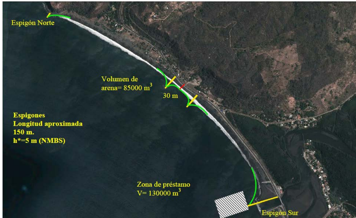
Figura 13. Esquema demostrativo de la solución planteada por LIMF 2013, como la más recomendable para atender el problema actual en Caldera.
