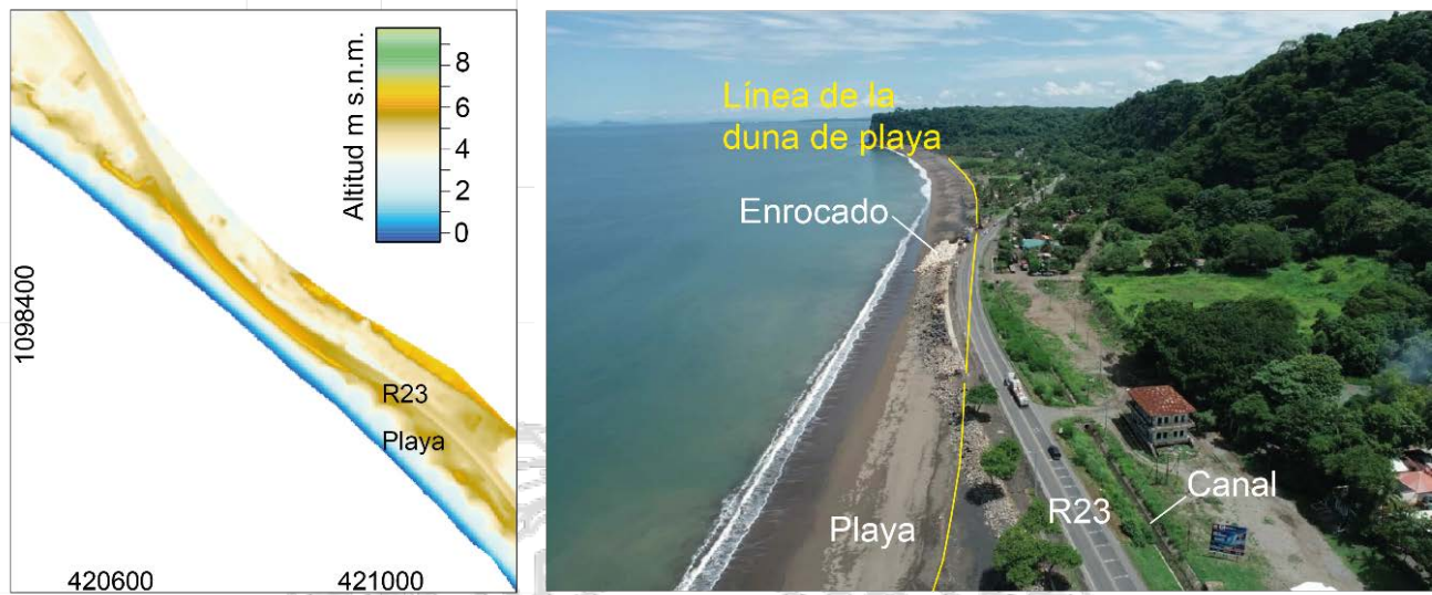
Figura 9 A la izquierda se muestra un modelo generado con LiDAR. En la fotografía aérea de la derecha, se aprecia la carretera y el enrocado sobre la duna de la playa. En ambas se puede apreciar como la RN-23 invadió la morfología de la zona alta de la playa
