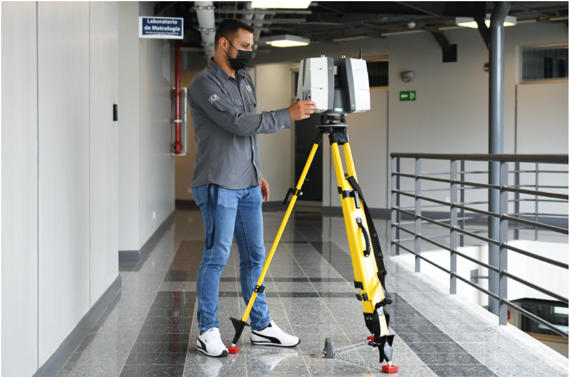
El escáner láser P40, adquirido por la Escuela de Ingeniería Topográfica de la UCR, se emplea en actividades de investigación y para apoyar los trabajos de conservación de los edificios patrimoniales de nuestro país, explicó el Ing. Mauricio Varela. Foto: Laura Rodríguez.
