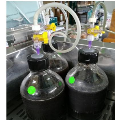
Evaluación del potencial de producción de biogás a partir de la fracción líquida en microrreactores de 750 mL
