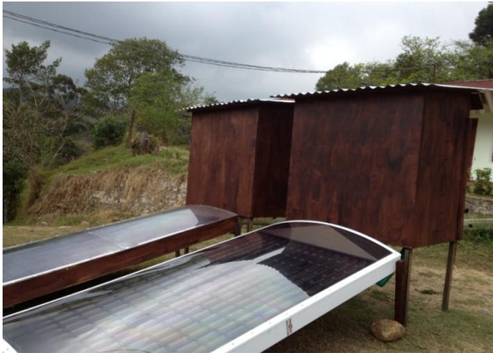
Se lograron eficiencias de secado de 80 % y 76 % para el secador tico y secador canadiense respectivamente. Los que representa diferencias respecto al secador de convección natural tico de hasta 62 %.
