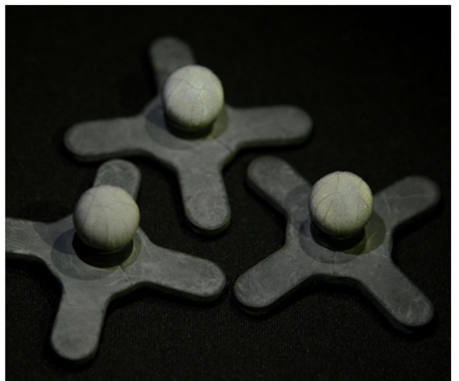
Sin necesidad de baterías los marcadores pasivos se encargan de reflejar de manera fiel los movimientos; versiones más pequeñas pueden colocarse en los dedos o la cara para asegurar una réplica exacta de todos los detalles (foto cortesía PRIS-Lab UCR).
