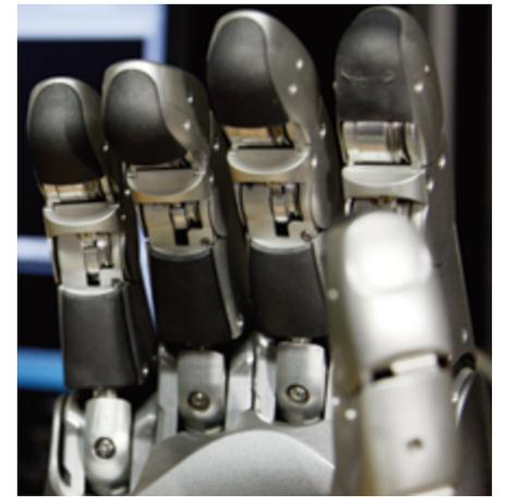
El Arcos-Lab expuso una prótesis robótica que simular los tendones de una mano humana y un sistema de sensación retroalimentador que asemeja las sensaciones por medio de electrodos (foto Laura Rodríguez).
