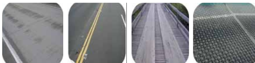
Figura 17. Tipos de superficies de desgaste: Concreto, carpeta asfáltica, tablonés de huella y rejilla de acero dentada.
